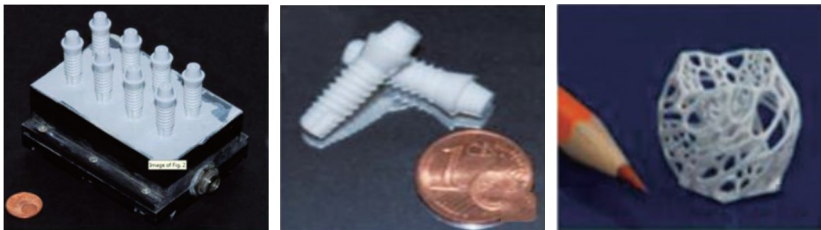
图 3 基于数字光处理技术成型的 ZrO 2 种植体和 ZrO 2 工艺制品
