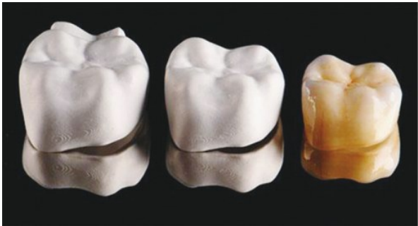
图 4 使用 LCM 技术制备的 ZrO 2 全瓷冠
