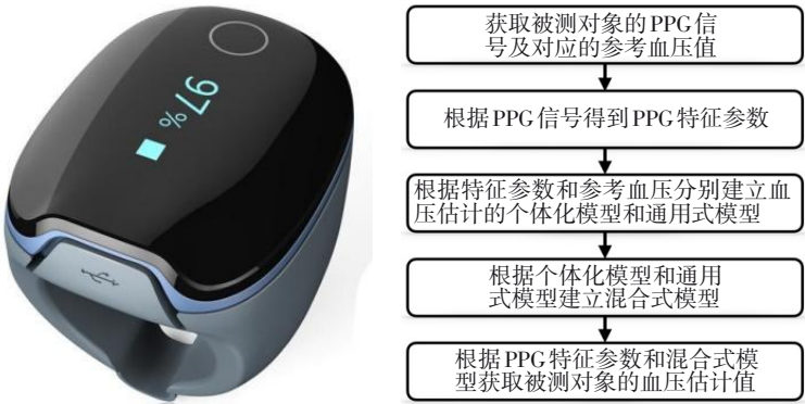
图 1 O2Ring（PO2）指环（左）及其预测算法流程（右）
